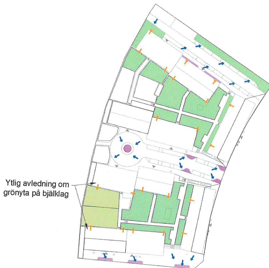
Figur 16 Ytlig avrinning från hårdgjorda markytor (blå pilar) samt taktytor (orange pilar)
