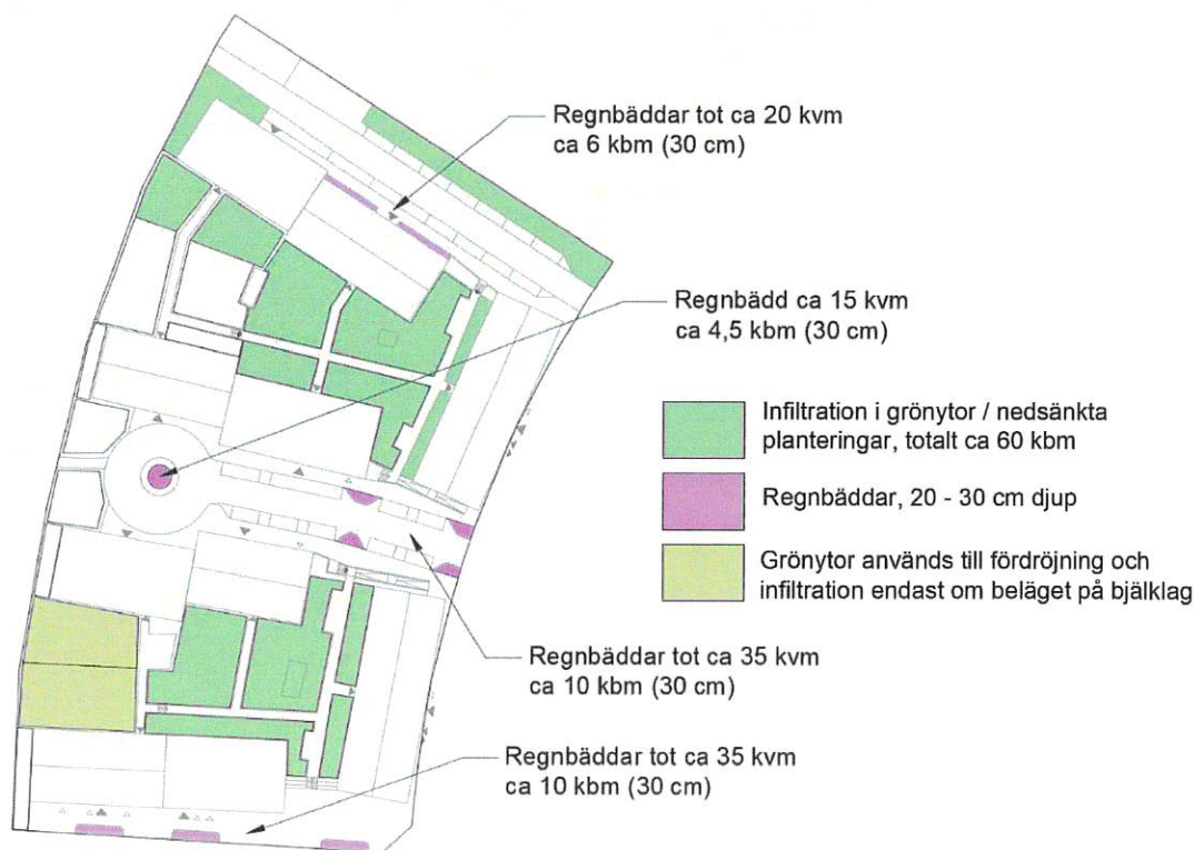
Figur 15 Förslag på hantering av dagvatten. Grönytor med upphöjda bräddavlopp samt regnbäddar används till infiltrationsytor från tak och hårdgjord mark
