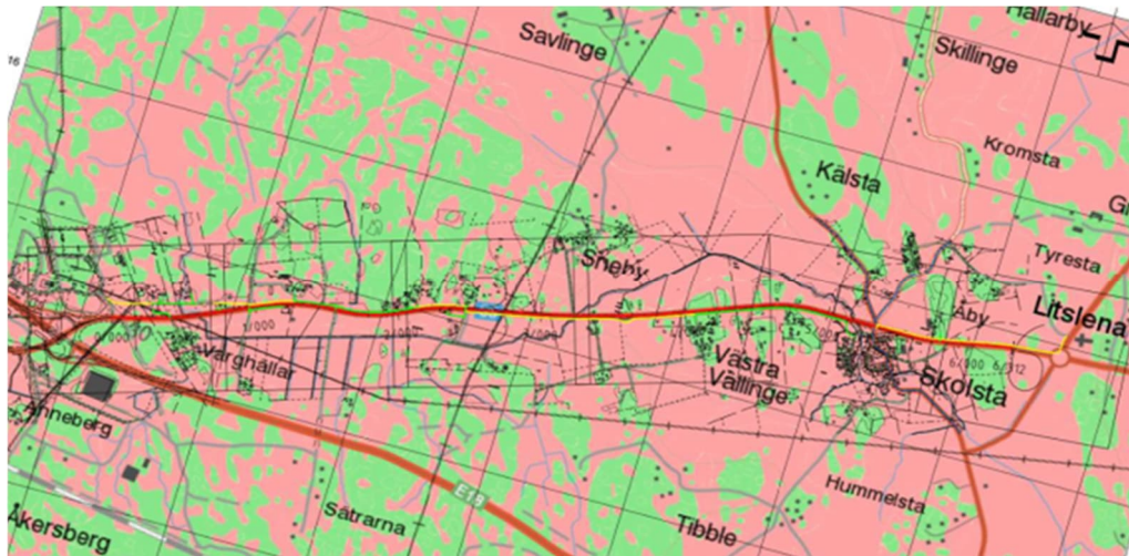
Figur 6. Vägsträckningen som lager på SGU geologiska fastmarkskarta redovisar fastmark i grönt och lösmark i rosa
