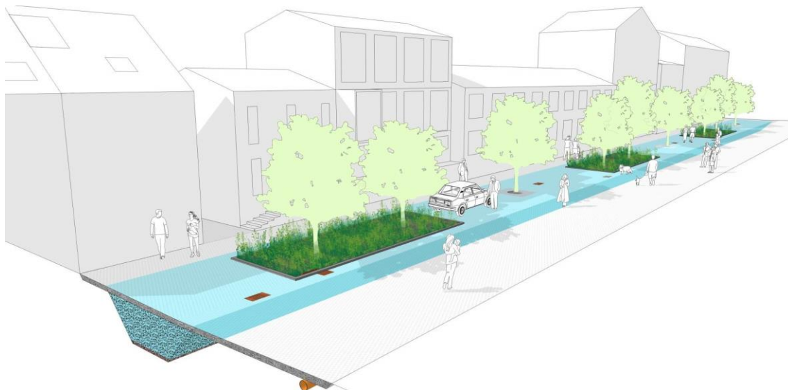
Figur 21. Schematisk skiss över ett öppet förstärkningslager under en gata, med regnbäddar och träd i anslutning. Illustration: Edge (Fridell m.fl., 2023).
