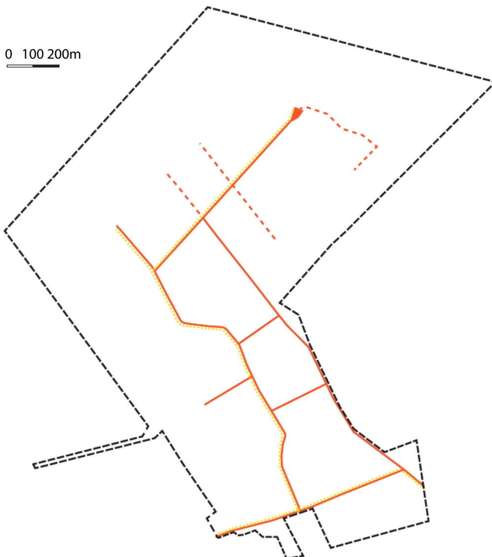
Bild 47. Pictogram över den reviderade strukturplanens vägnät och möjliga lägen för gång- och cykel samt stadsbuss.. Gul streckad linje är gång- och cykelväg, orange heldragen linje är kommunal gata och streckad orange linje är möjliga kvartersgator. Behov av kvartersgator och dessas lägen utreds vidare under kommande detaljplanprocesser.
