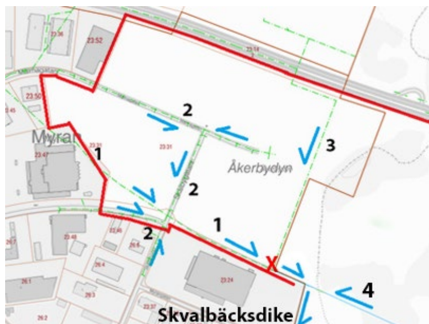
Figur 24. Dagvattenledningar för såväl dagvatten som för bakgrundsvatten (ledning 1 och 3) inom planområdet
