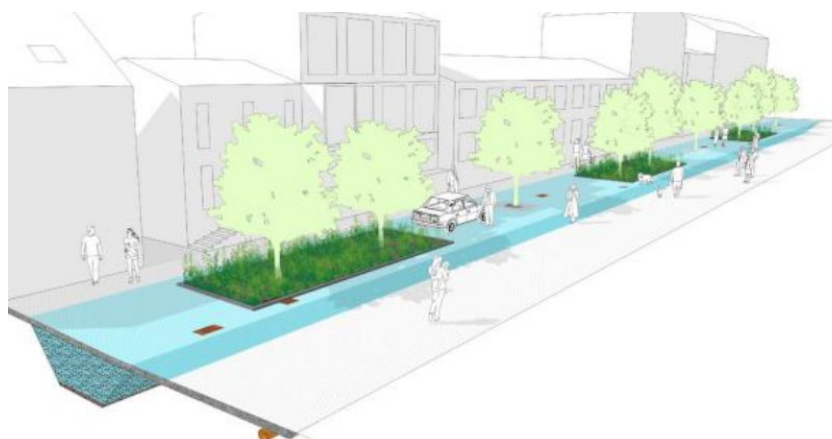
Figur 47. Gaturum med blå-gröna-grå (BGG) system. Källa: Dagvattenutredning, Rejlers Sverige AB, 2025.
