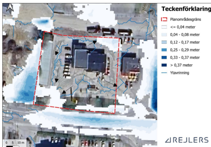
Utdrag ur dagvattenutredningen som visar befintliga lågpunkter och avrinningsvägar vid ett skyfall.
