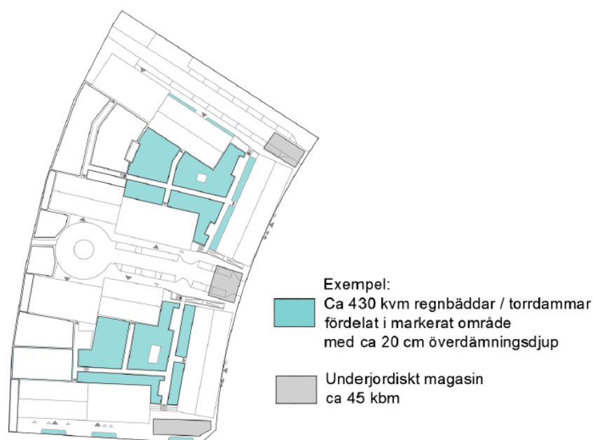
Figur 23. Schema som visar ytliga (regnbäddar, överdämningsytor, översilningsytor o.d.) och underjordiska dagvattenanläggningar som tillsammans kan skapa erforderlig fördröjningsvolym på 130 m 3
