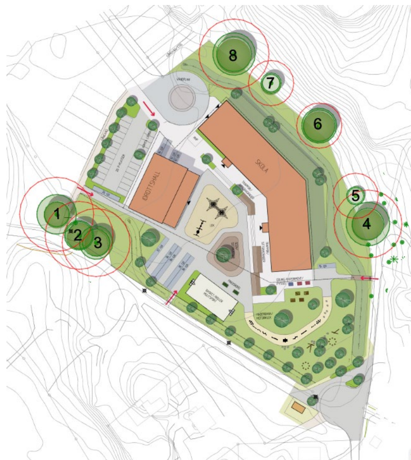
Figur 23. Illustrationsplan med de skyddsvärda träden och dess skyddsavstånd markerat med rött, ETTIELVA ARKITEKTER 2024, bearbetad av WSP 2024.
