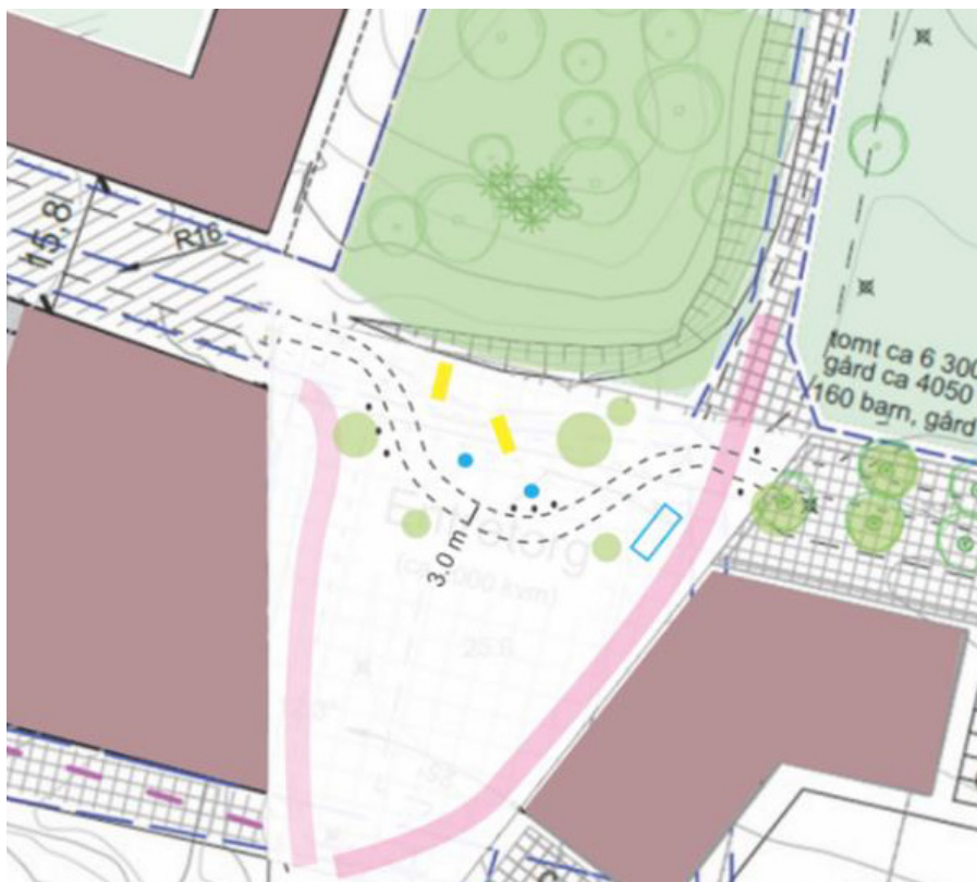
Karta 19. Föreslagen utformning för att säkerställa utryckningsvägar över torget. Observera att kartan är från den fördjupade trafikutredningen som legat till grund för detta planprogram. Vissa korrigeringar i planförslag och benämningar har gjorts.
